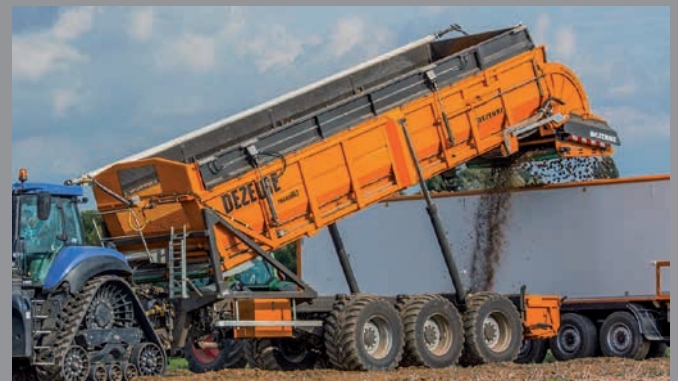
TURBOCLEANER: haalt nutteloze aarde uit je lading TURBOCLEANER: sépare la terre inutile de votre charge
